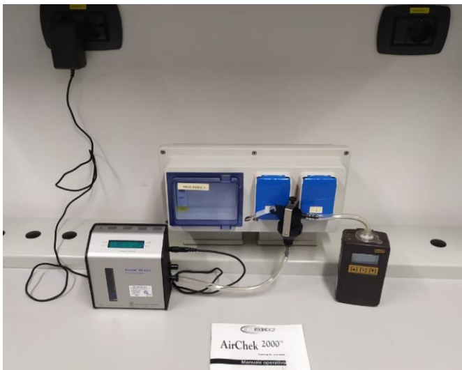
Fig.8: Calibrazione del flusso di aspirazione del sistema pompa – preselettore IOM
